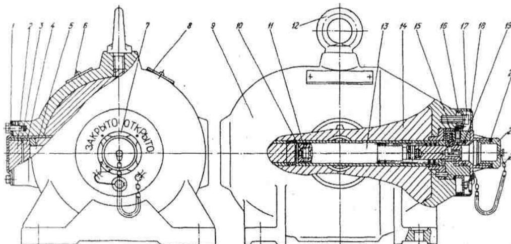
1,18,21- крышка; 2,4- экран защитный; 3- кассета; 5- пробка; 6- шильдик; 7- рукоятка-индикатор; 8- планка фирменная; 9- кожух; 10 - держатель; 11- источник гамма-излучения; 12 - рым-болт; 13 - шток; 14-защита радиационная; 15- устройство замковое; 16 - фланец; 17 - болт; 19- кольцо уплотнительное; 20 - прокладка; 22 – цепочка.
